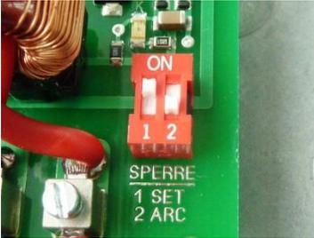
Bevor Sie die Stringleitungen auflegen, wird der Schalter SPERRE SET auf **ON** gestellt. Dadurch wird verhindert, das während der Installation das Gerät in den Kurzschlusszustand übergeht. Nach der Installation wird der Schalter wieder zurückgestellt.
