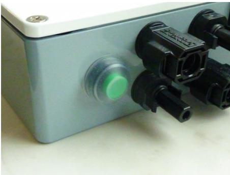
Der Aus-Taster wird durch **Drehen** entriegelt. Nach dem Entriegeln bleibt der Kurzschluss weiterhin bestehen. Zum **Rücksetzen** muss man den Rücksetztaster betätigen. Bei gedrücktem Aus-Taster kann man nicht Rücksetzen!!
