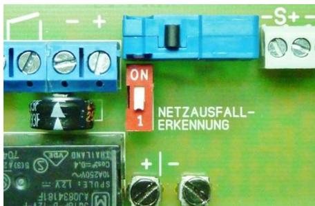
Die Funktion Netzausfall-Erkennung wird aktiviert, indem der DIP-Switch auf **On** gestellt wird. Der DIP-Switch befindet sich im Fernschalter.
