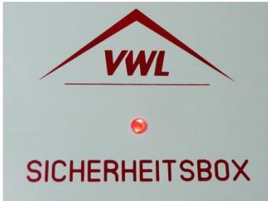
Die optische Anzeige von seriellen Lichtbögen erfolgt durch Blinken der **LED ROT**.
